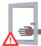
Greifen Sie beim Schließen von Fenstern sowie Fenstertüren niemals in die Öffnung zwischen Flügel und Blendrahmen!
