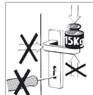
Der Drücker darf nur im normalen Drehsinn belastet werden. In Betätigungsrichtung darf auf den Drücker max. eine Kraft von 150 N aufgebracht werden. Das Schloss bzw. die Mehrfachverriegelung darf nur mit zugehörigem Schlüssel (und nicht mit artfremden Gegenständen) geschlossen werden.
